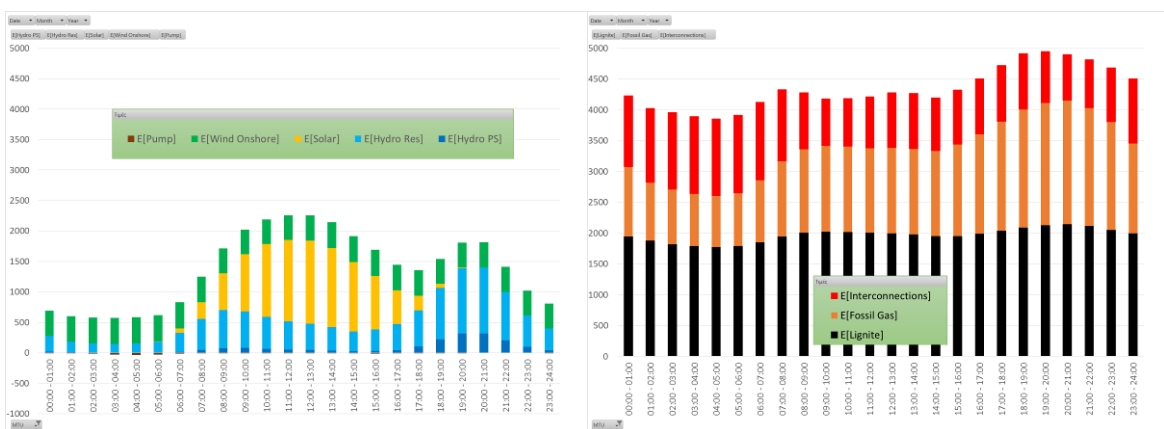
Εικόνα 2: Μέση ωριαία ζήτηση ισχύος – ΥΗΣ & ΑΠΕ (αριστερά), Θερμικά & Διασυνδέσεις (δεξιά).
